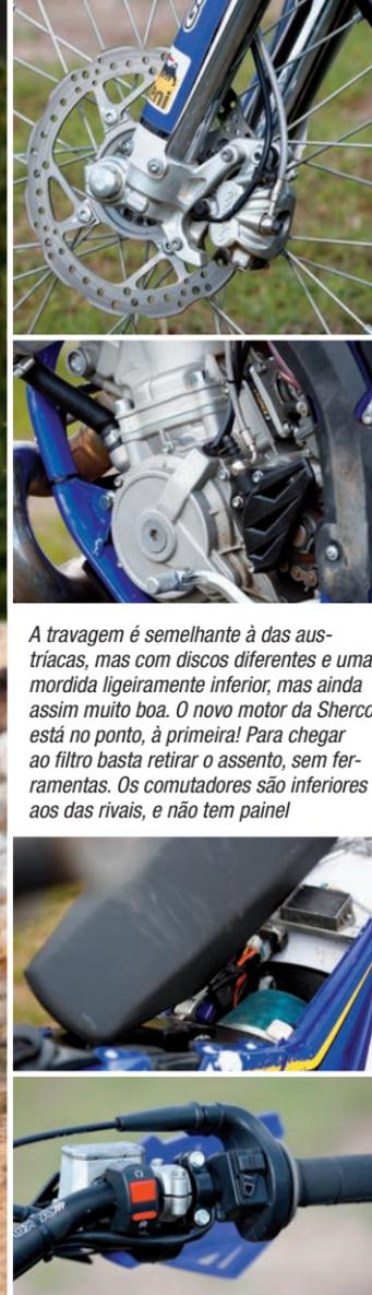
A travagem é semelhante à das austríacas, mas com discos diferentes e uma mordida ligeiramente inferior, mas ainda assim muito boa. O novo motor da Sherco está no ponto, à primeira! Para chegar ao filtro basta retirar o assento, sem ferramentas. Os comutadores são inferiores aos das rivais, e não tem painel
