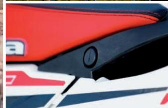
A travagem é forte na Beta, com disco Braking e hidráulicos Nissin. Para retirar o assento e aceder à bateria basta carregar no botão da foto acima, e para o filtro-de-ar é só puxar a tampa lateral, tudo sem ferramentas. O painel digital é apelativo e tem muita informação
