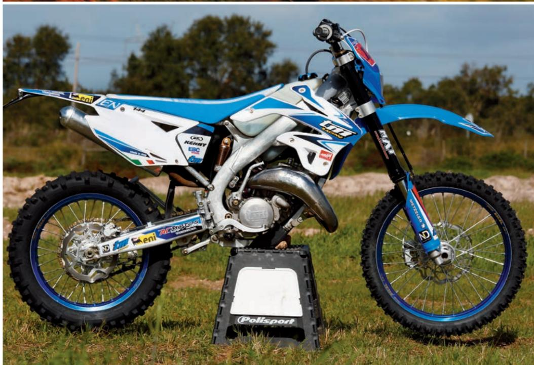
As TM têm quadro totalmente em alumínio, um dupla-trave ao género das Honda de MX. Toda a moto 'respira' competição e isso está patente também nos pormenores, como as peças maquinadas do bloco. O motor é potente e exigente. Tem protecção de cárter de série e um depósito de gasolina translúcido
